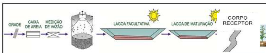
Figura 87 – Fluxograma típico de um sistema de tratamento com reatores UASB seguidos por sistema de lagoas
