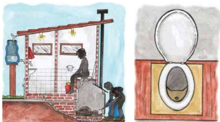
Figura 105 – Banheiro seco com bacia sanitária segregadora de urina
