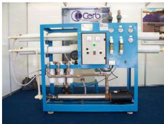
Figura 83 – Dessalinizador de água por osmose reversa
