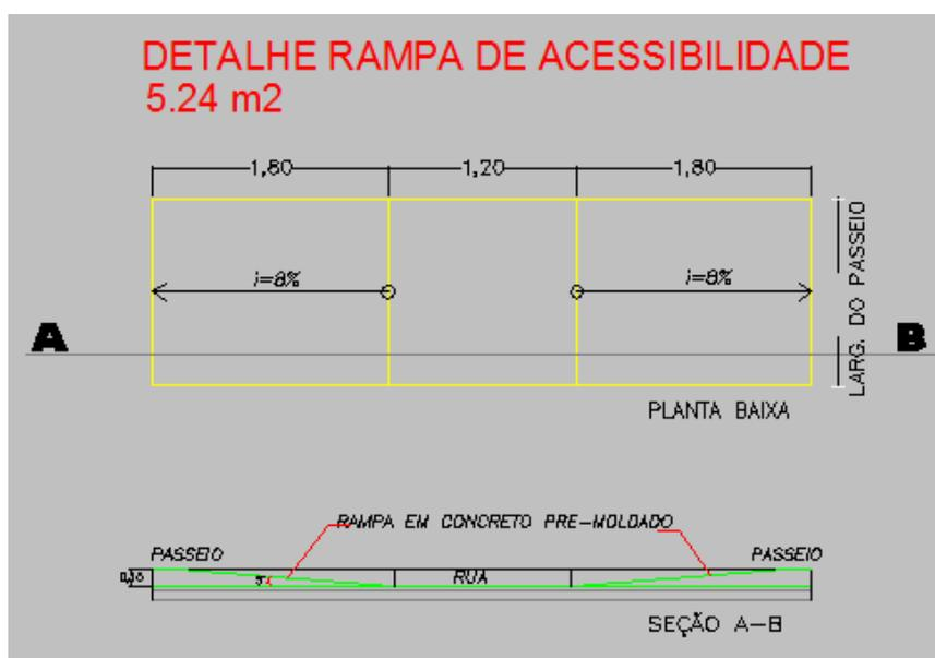
Figura 03 – Detalhe rampa de acessibilidade
